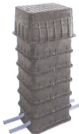
Šachta MODULO 2 Výškově stavitelný rám Výška 115 až 130 cm, poklop do 12,5 t
